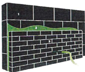
1. Dragende muur | 2. Ingeblazen isolatie | 3. Gevelsteen / gevelbekleding
